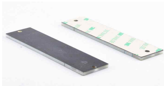
<그림 19> 금속형 Passive RFID 태그
